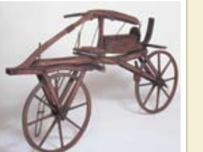
ドイツのドライス男爵が考案した世界最初の自転車「ドライジーネ」。2輪を並べたもので、ペダルもクランクもない。
