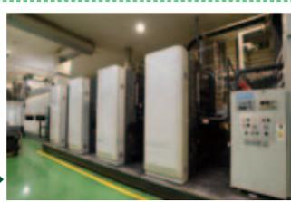
2 黒系K(ブラック)、青系C(シアン)、赤系M(マゼンタ)、黄系Y(イエロー)の4色のペースト状のインクを順番にかけ合わせながら印刷。表裏同時印刷だ。
