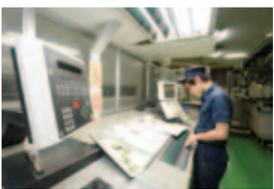
5 高性能カメラで、細かいシミや汚れの感知。さらに人の目での作業。オペレーターが、最終の色校正を見ながら、色味や汚れなどをチェックし修正、色調整をする。
