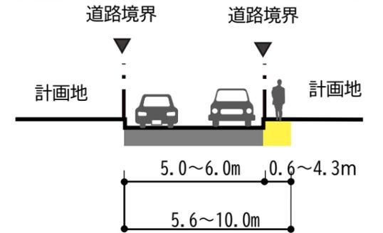
図表2 従後の道路整備状況及び主な道路の断面構成
