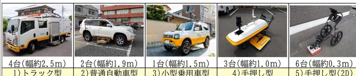
図2-1 自社開発した探査機材のラインアップ・保有状況
