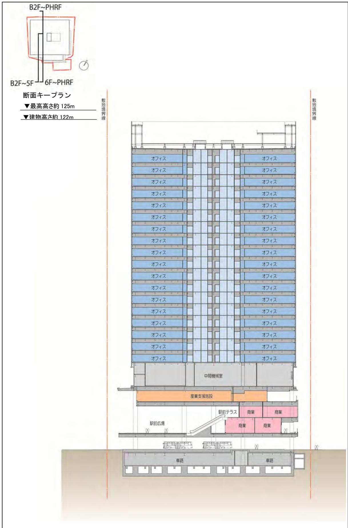
図 13.2.1-7 (1) 断面図 (S=1:800) 2-2 断面【変更後】
