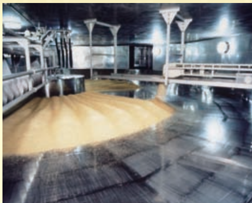
蒸した大豆と炒った小麦に麹菌を加えて、製麹室に盛り込んで発酵させる
