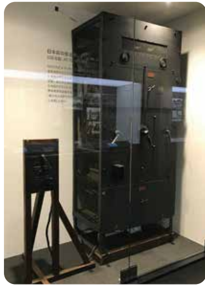
日本初のラジオ電波を送り出した送信機 GE社製AT702
