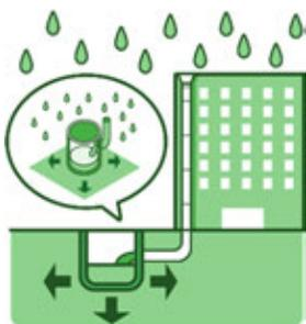
雨水浸透ます、雨水浸透管の設置
