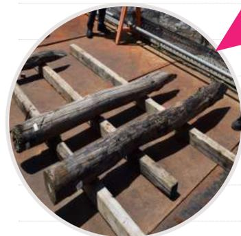
波消し及び海側の地盤補強を目的とした杭。2メートルほどの長さがあります。鉛筆削りで削ったかのように尖っていることが特徴的だそうです。
