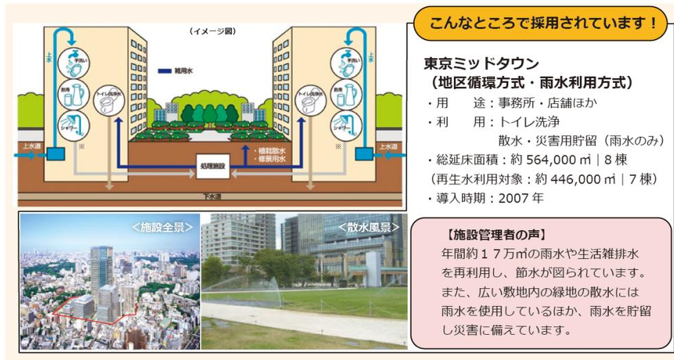
図 5-27 雨水利用の事例：ミッドタウン（地区循環方式・雨水利用方式）
