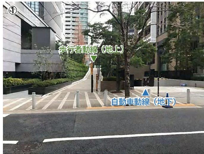
図表2.5-6 自動車通路（一部地下式）の整備による地上部の歩行者動線の確保
