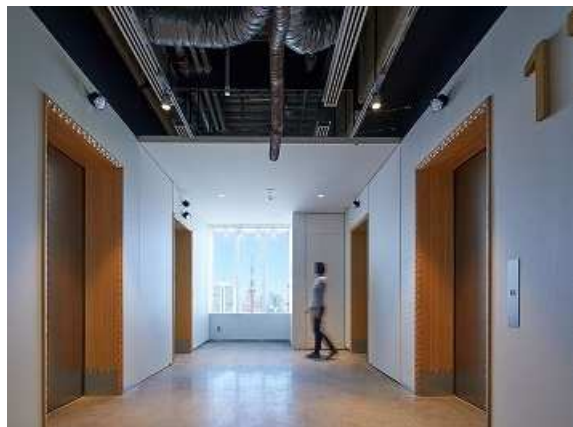
EVの三方枠にスギ材を使用し、表面には「名栗」の加工 天井部には広葉樹丸太を意匠として設置
