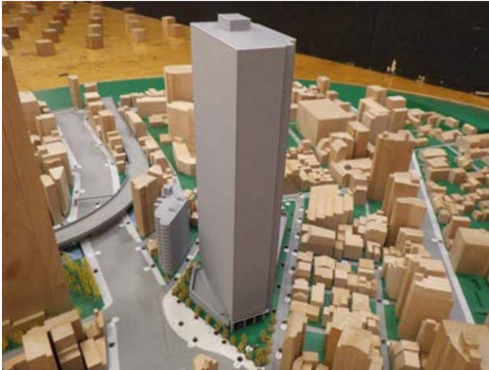
写真 2.6.2-2 防風対策実験状況
