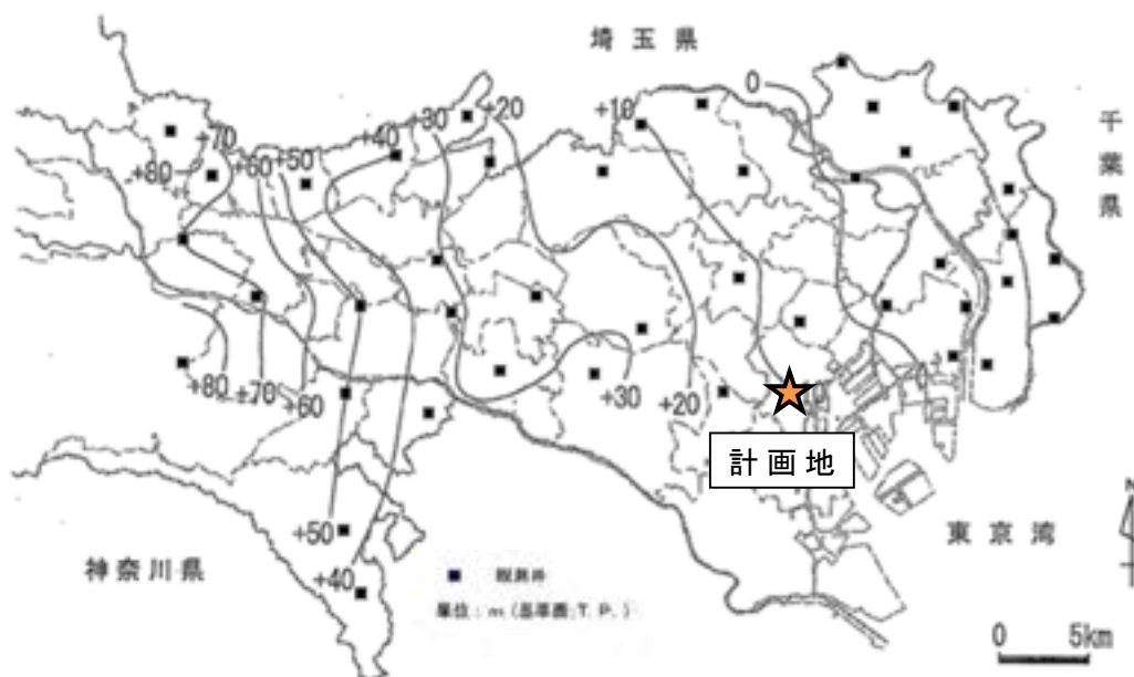
図 2.4.4-6 令和 4 年末の被圧地下水位等高線図
