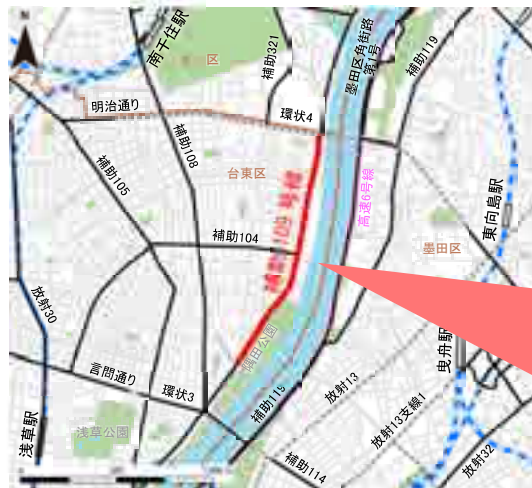
補助109号線 計画幅員20m 現道幅員約15m
