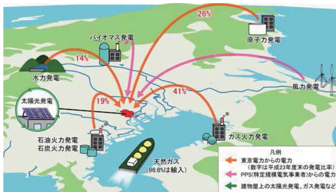
図2-9 電気、ガスの供給源の概要
