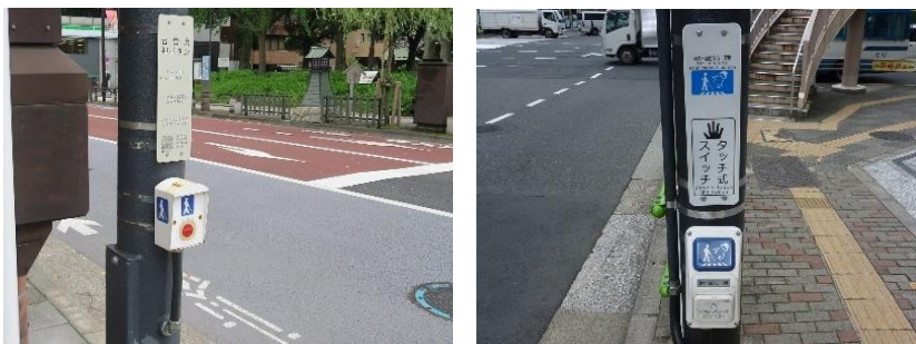
写真 港区にある視覚障害者用付加装置付信号（左：ボタン式 右：タッチ式スイッチ）
