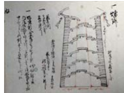
『江戸城造営関係資料集・藩師方里方瓦当持物本通内訳』に掲載された練塀の断面図
