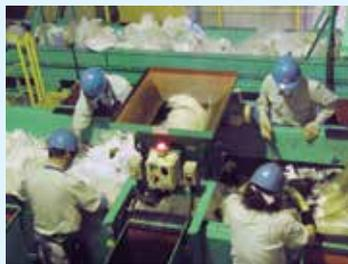
将袋子撕破去除混杂物时的情形
