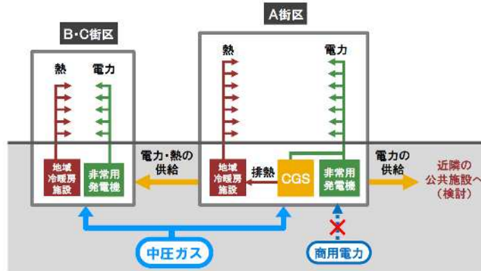
図 5-3 災害時のエネルギー等供給イメージ（商用電力停止時）
