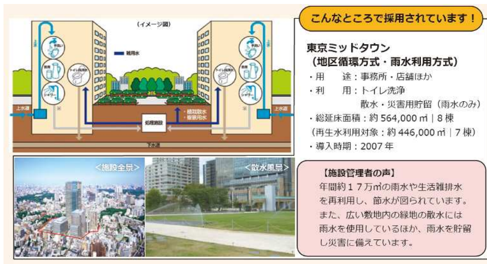
図 5-26 雨水利用の事例：ミッドタウン（地区循環方式・雨水利用方式）
