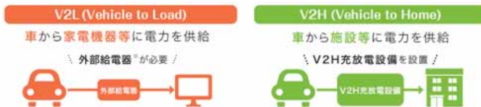
非常時等における EV からの電源確保
