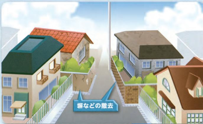
細街路に接した敷地で建築工事を行う場合、敷地に接した道路の中心から2m後退した位置と現況道路との間に存在する後退用地について、下記のように、順次拡幅していきます。
