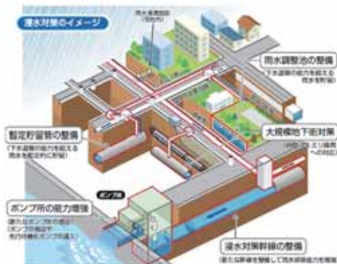
下水道の浸水対策
