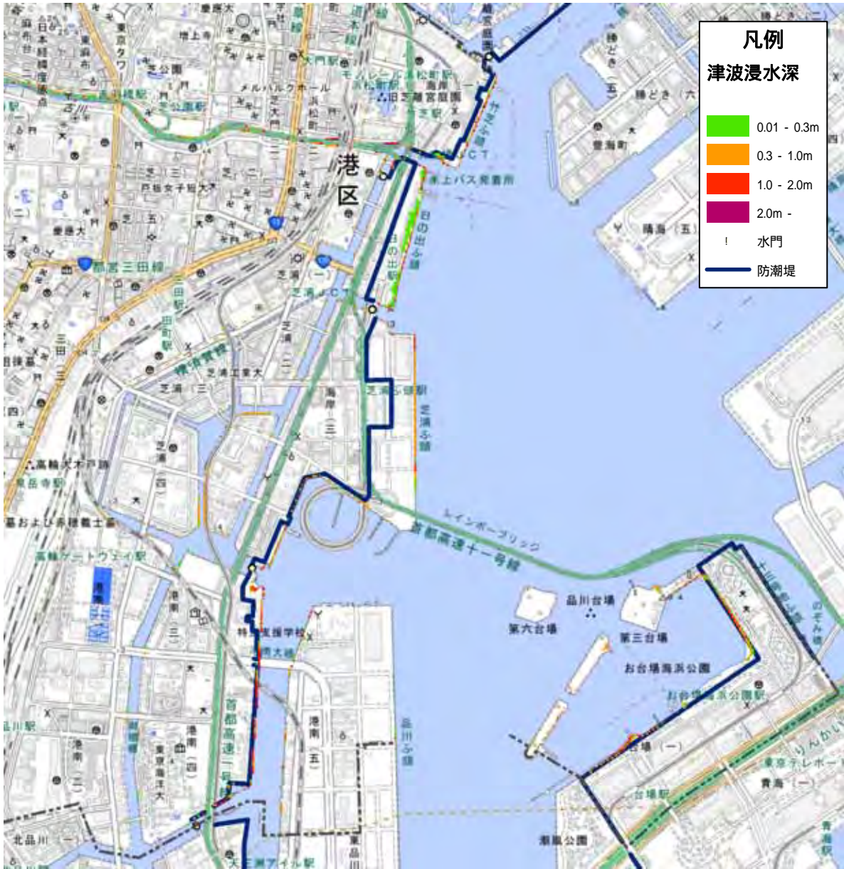
図 12 R4.5 東京都想定による南海トラフの巨大地震（M9.1）の浸水域
