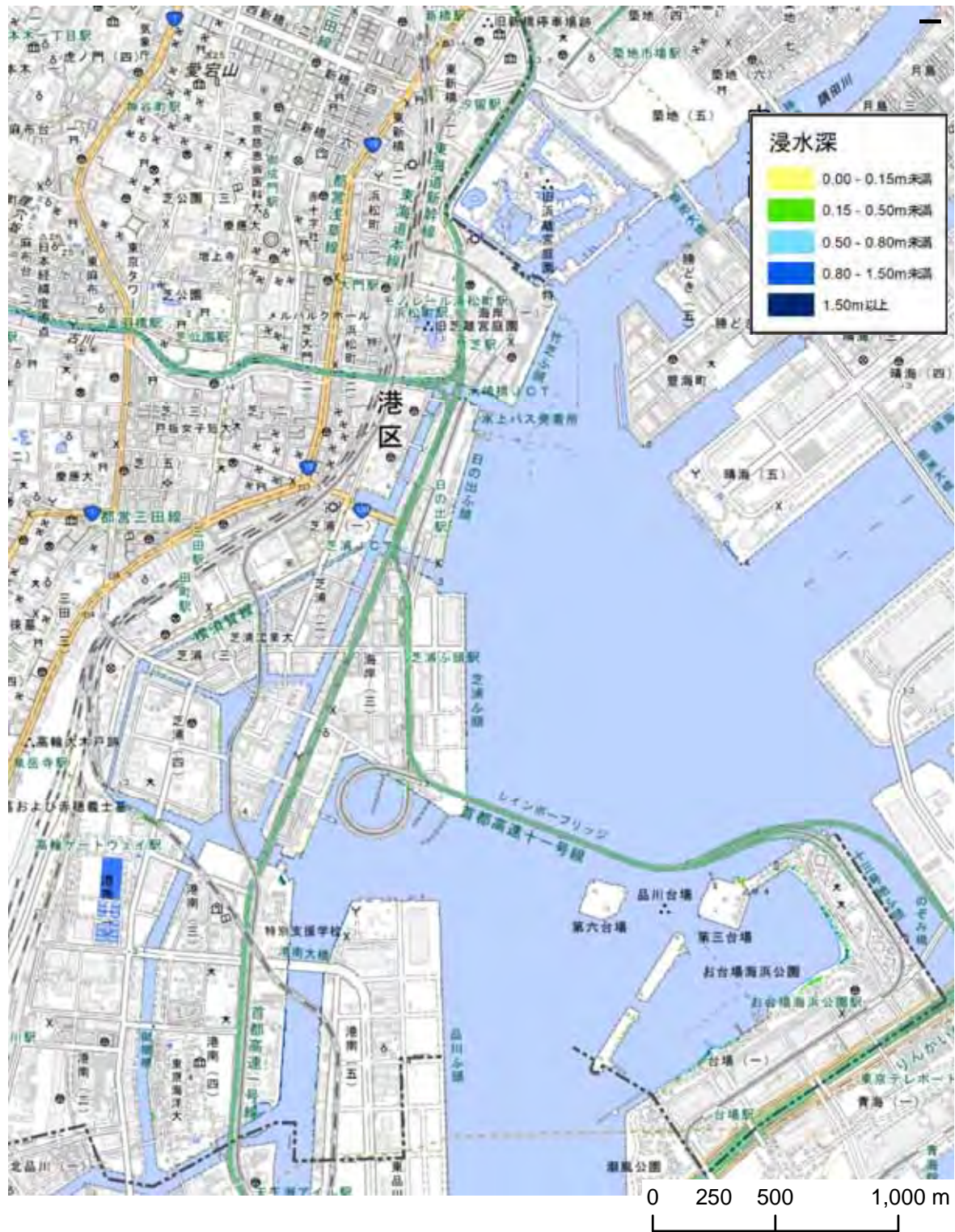
図 35 津波浸水予測図④（防潮施設機能健全 液状化あり（平均的な条件））
