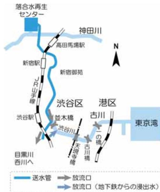
古川に導入されている下水高度処理水、地下鉄からの浸出水の流れ
