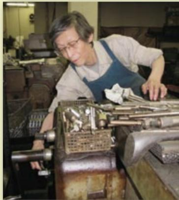
ネジを早く、正確につくれる都内最大級の転造ローラーダイスという機械を何台も備えています。口径2mm~80mmまで、様々な大きさのネジをつくることができます。大きいものでは、クレーン車の備品に使うネジで備品の重さが数十kgになるものもあります。最近では点滴に使う精密な医療機器のネジの注文もありました。父の時代、皇居新宮殿のシャンデリアのワイヤーを止めるネジを現場でつくったこともあります。ネジ切り加工のスペシャリストとして、どこにも負けない自信がありますよ。」
