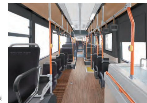
木調素材の連節バスの内装
